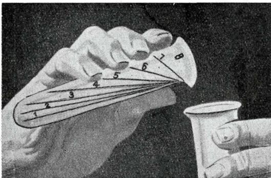
Una provetta graduata coi segni inclinati in modo da poter leggere in qualsiasi momento la quantità di liquido contenuto.
