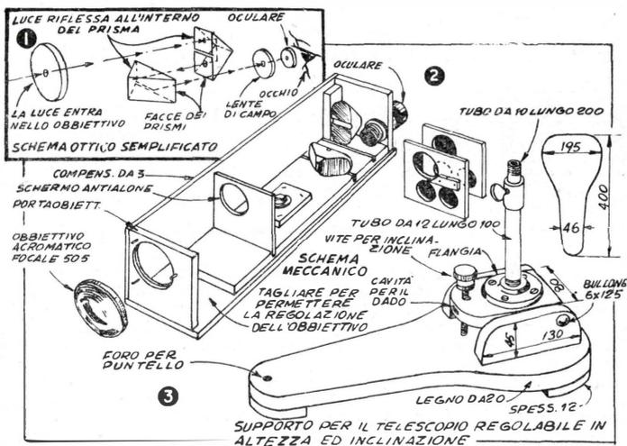
L'esempio più comune di questo tipo di strumento ottico lo si trova in un binocolo tra i tipi più perfezionati. Lo strumento che presentiamo è stato particolarmente studiato per i casi in cui necessiti una visione dettagliatissima di un campo di piccola apertura, a grande distanza: può aiutare ad esempio nella presa della mira nel caso di tiro a segno di precisione e di grande distanza.
