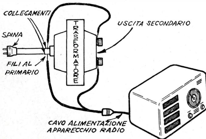
Se la ricezione della vostra radio, a causa della bassa tensione di rete, lascia alquanto a desiderare, potete migliorarla alquanto con l'uso di un semplice trasformatore per campanelli della potenza di una diecina di watt almeno.
