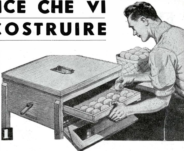
fermo al suo posto per mezzo di chiodini sottili. Sul cartone o masonite vanno installate, nel modo illustrato, le bordure, le guide per i pannelli scorrevoli, ed il termostato; infine il coperchio, esso pure foderato di cartone ondulato, va avvitato al suo posto. Nella figura 6, il dettaglio A illustra la veduta del fondo ed il dettaglio B quella dal fianco.
