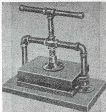
il manicotto di accoppiamento che si trova fissato alla estremità inferiore del tubo stesso va ad agire sul collo della terza flangia, avvitata al centro del blocco di pressione. Con tale sistema il sollevamento del blocco di pressione va fatto a mano.
