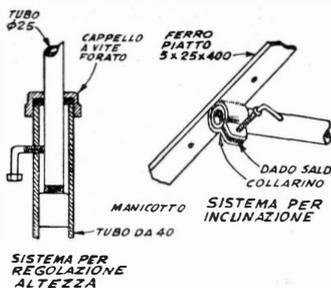
che si impanano in due dadi saldati ciascuno ad una faccia esterna delle fascette di ogni collarino. A metà circa della lunghezza dei bulloni di serraggio va saldata, nella posizione indicata nelle illustrazioni, una rondella di buono spessore. Il piano di lavoro è costituito da un rettangolo di buon legno sulla cui faccia superiore è consigliabile l'applicazione di un foglio di linoleum o di altro laminato plastico.
