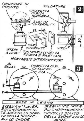
neria. nel modo indicato in fig. 2 (eventualmente, la chiavetta per la carica della suoneria, se di dimensioni troppo ridotte, andrà modificata saldandovi un rettangolino metallico). Il fissaggio dell'interruttore va fatto dopo che la carica della suoneria sia stata quasi del tutto completata. L'importante è che l'interruttore a levetta si trovi in posizione tale per cui venga fatto scattare dalla chiavetta della suoneria non appena questa entri in funzione.
