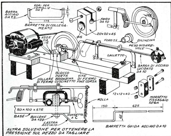
metallo, è bene, allo scopo di evitare un rapido danneggiamento, fare un pezzetto di tubo, una specie di bronzina, anche nel foro della puleggia è consigliabile introdurre e saldare un simile pezzetto di tubo, per evitare l'eccessivo gioco laterale dell'insieme.
