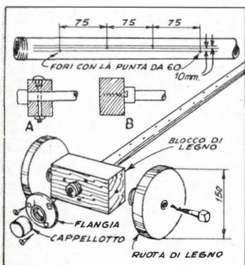
tubo che deve stare rivolta verso l'alto, ma con uno spostamento laterale di 10 mm. Come vedete, il quarto foro si trova nella stessa direzione del primo, il quinto in quella del secondo e così via. E' essenziale che tutti i fori siano praticati mantenendo la punta del trapano diretta verso l'asse centrale del tubo.
