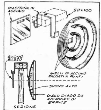
zione del disco, gli anelli concentrici vanno fissati ad esso per mezzo del minimo indispensabile di punti di saldatura. E in oltre, buona precauzione, quella di addossare il bersaglio ad un muro o ad un mucchio di terra.
