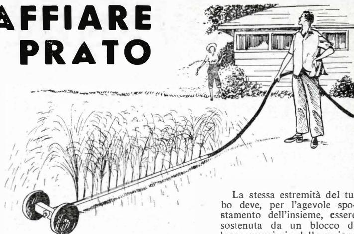
La stessa estremità del tubo deve, per l'agevole spostamento dell'insieme, essere sostenuta da un blocco di legno massiccio della sezione di 5x8 cm. al centro delle cui testate sono fissate due rotelle di legno del. lo spessore di almeno 30 mm. e del diametro di una quindicina di centimetri, imperniate su due grosse viti a legno. L'attrito tra le parti in legno è stato evitato con l'interposizione di rondelle metalliche di adatto spessore.
