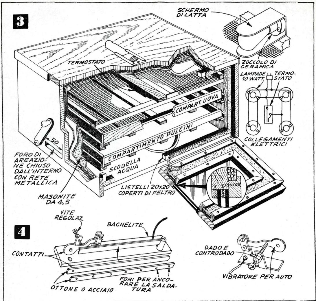
tal modo facilmente asportabile per la periodica lavatura. Pure lo sportello dell'incubatrice è isolato termicamente: possiede infatti un cuscinetto di aria di circa 5 mm. tra i due vetri che ne costituiscono la finestrella di osservazione (vedere dettaglio apposito, in fig. 3). Le infiltrazioni di aria attraverso le connessioni dello sportello vengono impedito con delle guarnizioni di feltro.
