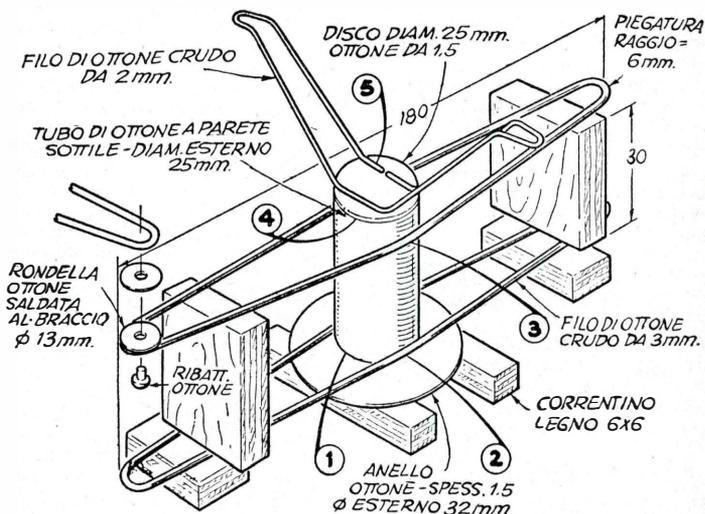
Il montaggio di ogni elemento risulterà più agevole nel caso che si faccia uso di alcuni blocchetti di legno che servono da guida. Con tale sistema, iniziare posando il pezzo di tubo che servirà da portacandela, capovolto, sui blocchetti centrali e saldando ad esso le varie parti seguendo l'ordine indicato dalla numerazione del disegno.
