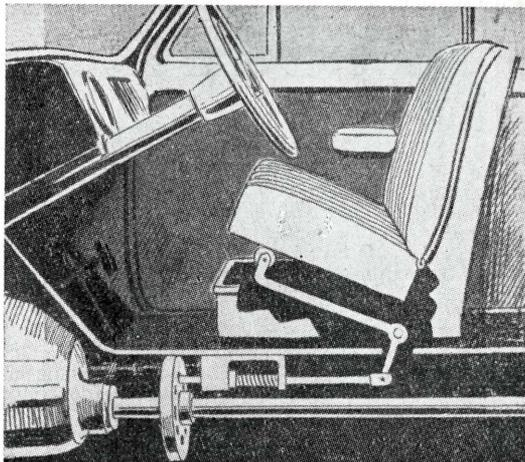
Un bloccaggio automatico capace di arrestare una macchina il cui conducente abbia dimenticato di tirare il freno a mano o di innestare la marcia. Il meccanismo a molla bloccherebbe l'auto, e non si libera finché qualcuno non si siede al posto di guida.
