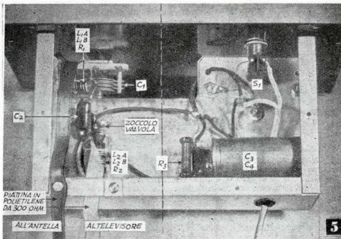
La linea tratteggiata che divide la foto di qui sopra e lo schema elettrico di qui sotto divide in due parti il circuito ed il montaggio del preamplificatore. I collegamenti della parte a destra del tratteggio non richiedono particolari attenzioni. Tutti i conduttori della parte a sinistra, invece, (eccezione fatta per quelli in piattina da 300 ohm in polietilene), debbono essere quanto più brevi possibile.
