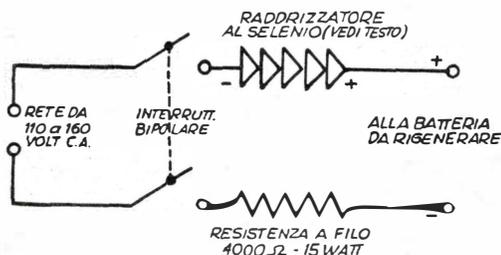
Schema elettrico del dispositivo, notare l'estrema semplicità dell'insieme. Attenzione alle scosse: anche il polo negativo dell'uscita può trovarsi a tensione superiore a quella di terra e non deve pertanto essere toccato.
