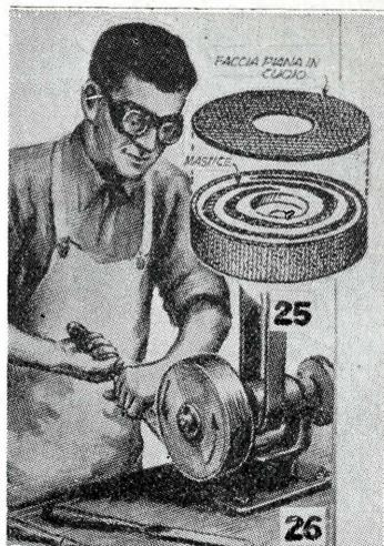
te di capovolgere la testata del trapano stesso, ma in taluni casi potrà bastare il fissare la ruota abrasiva al mandrino dello stesso, senza nemmeno capovolgerne la testata. Questo caso si verificherà quando lo spazio tra il mandrino portapunte ed il piano di lavoro sarà sufficiente.
