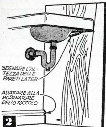
forma non rettangolare, vi si presenterà la necessità di costruire la flangia di contorno ad esso il cui scopo è quello di permettere la costruzione dell'armadietto in forma rettangolare, che è anche la più facile da realizzare. Quasi certamente il lavandino sarà fornito di un anello che ne contorna l'orlo, in caso contrario, sarà necessario provvederlo con un pezzo di profilato di alluminio a «T», che va piegato in modo da seguirne fedelmente i contorni.
